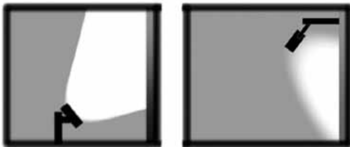
Ryc. 56. Przykład nieodpowiedniej (z lewej) i przyjaznej ptakom iluminacji budynków (źródło: www1.toronto.ca/staticfiles/city_of_toronto/city_planning/zoning_environment/files/pdf/development_guidelines.pdf )
